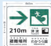
避難誘導標識
