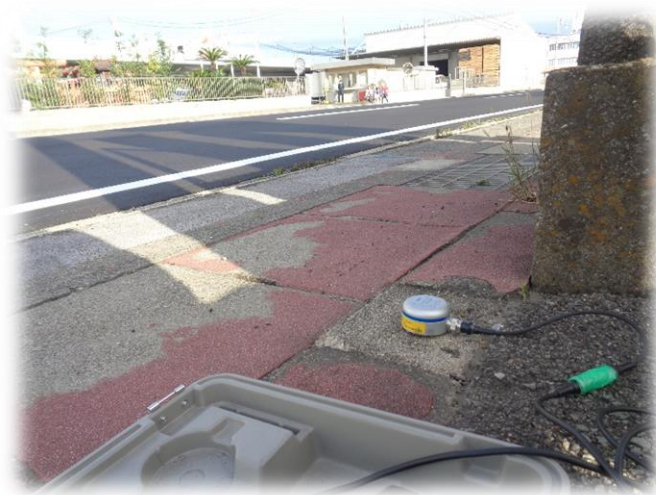
道路振動測定
