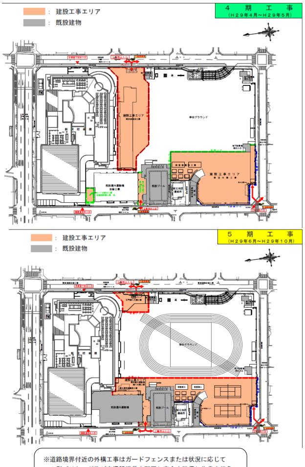
※直路境界付近の外構工事はカードフェンスまたは状況に応じて A型バリケード及び交通誘導員を配置し安全を確保し作業を行う。 ※東面道路改修工事は学校・警察等と協議の上、生徒及び第三者の 安全を確保できる仮設計画を検討し作業を行う。
