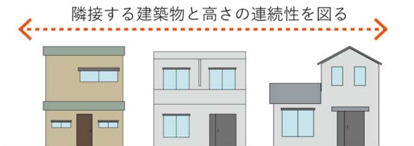
図 2-5 低層建築物の高さの考え方
