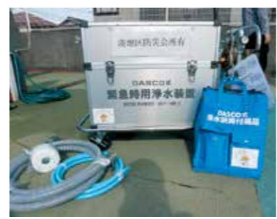
湊地区防災会が整備した緊急時浄水装置
