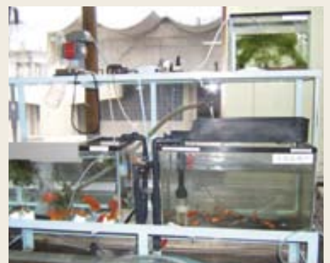
魚類監視装置
