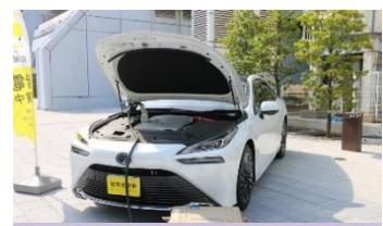
電動車両による給電対応
