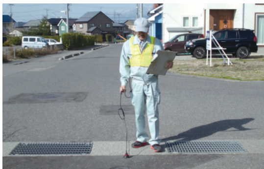
漏水調査状況
