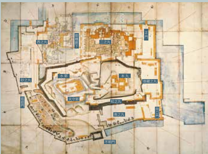
和歌山城內建築平面圖 (和歌山縣立圖書館珍藏) 約在1800年所制的平面圖。可以在此探索一下幕末時期的和歌山城面貌。每次新建或改修時都會繪製新圖剪貼在原圖上、是掌握城內建築物的一份基礎資訊。
